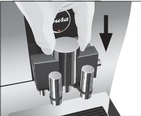
► Setzen Sie die Abdeckung des Kombiauslaufs auf. Vergewissern Sie sich, dass die Abdeckung des Kombiauslaufs richtig eingerastet ist.
