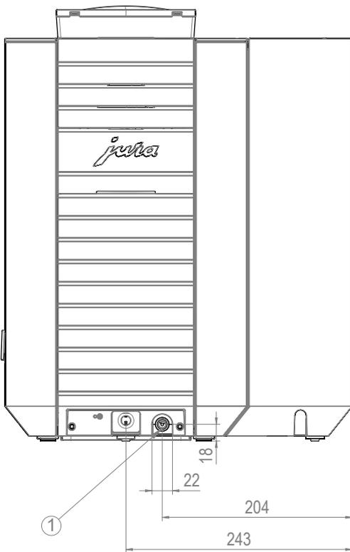
1 Position Restwasserschlauch
